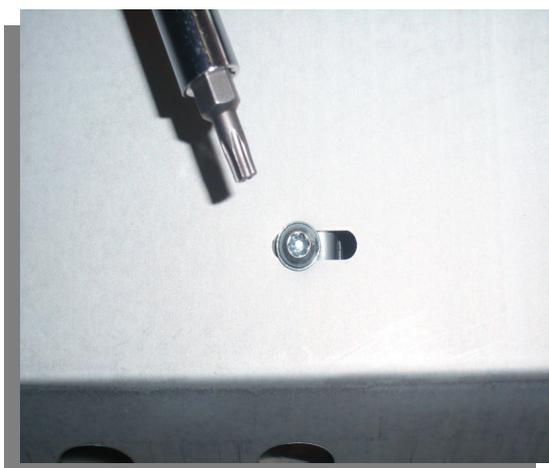
Accédez aux deux vis Torx disposées de part et d'autre du capot de protection
